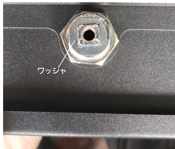
ワッシャを外す(軸から抜き取る)
