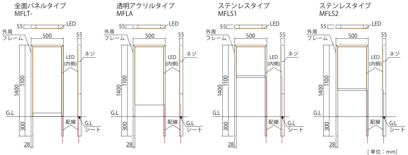
**注意** 12V(ローボルト)仕様ですので別売の専用トランス(12V変圧器)が必要になります。直接100Vに接続しますとLEDが故障いたしますのでご注意ください。
