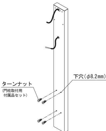
4. 宅配ボックスを門柱にあてがい、宅配ボックスの内側から付属のM4×25 SUSトラス小ネジで、付属の取付用パッキンをはめた上でしっかりと固定してください。
