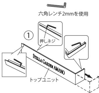
① 押しネジ(3箇所)をゆるめトップユニットをスライドしてはずします。
