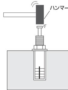
ハンマーでアンカーボルトの頭の部分を打ち込みます。
