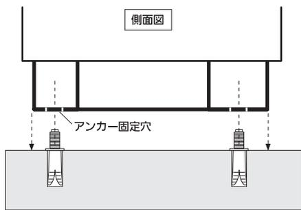
アンカーボルトを台座のアンカー固定穴に合わせ設置します。
